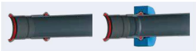
Fig. 1 coupe transversale avant et après le sertissage
